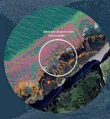
**TOPOCHRONIC** : étude diachronique, trait de côte et fissuration détection automatique des fracturations du platier rocheux
