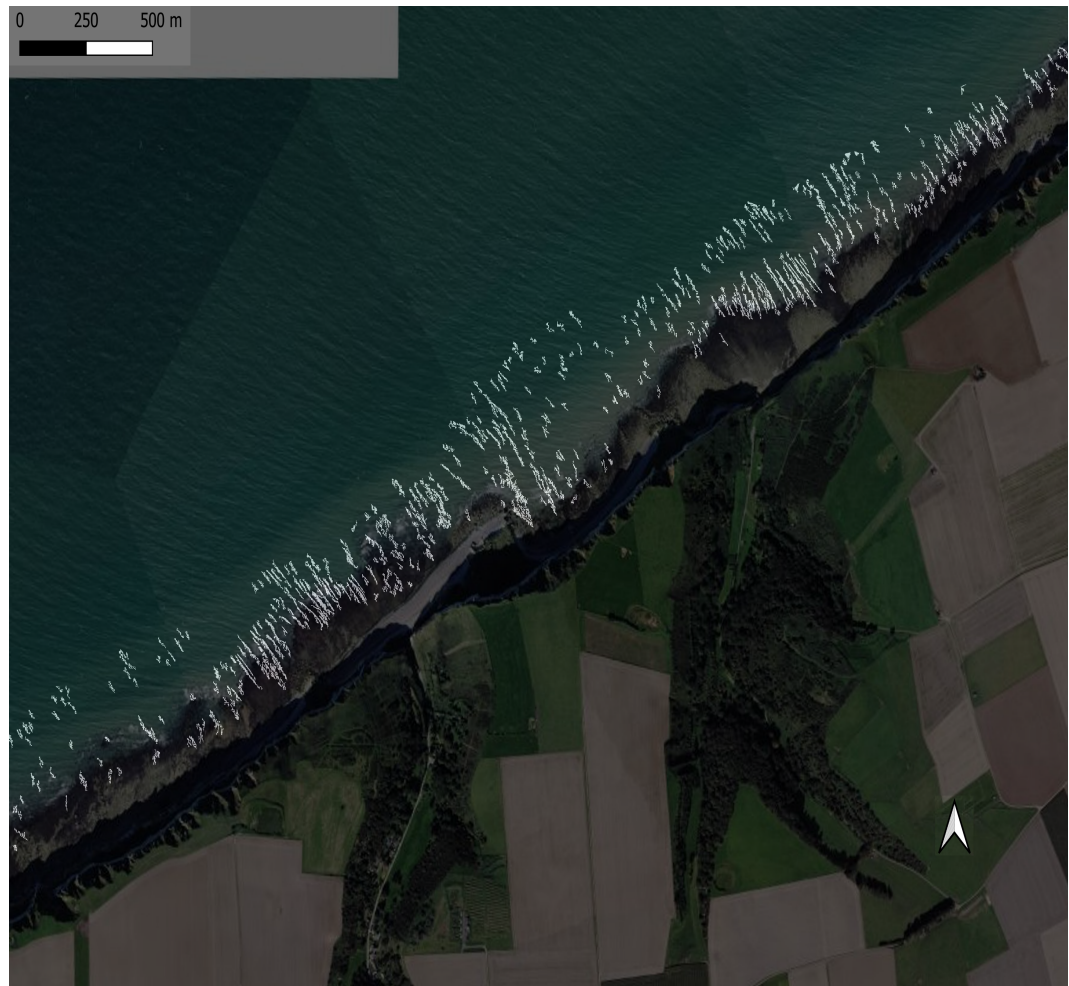
Figure 14 : Superposition des fracturations détectées sur l'orthophoto de la zone concernée [Source : Auteur]
