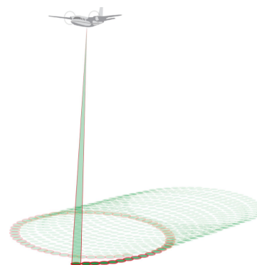
FIGURE 7 – Motif de Balayage oblique-elliptique Source : [Quadros, 2013]
