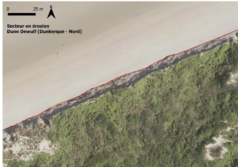
Figure 4 : position du trait de côte (en rouge) au niveau de la dune Dewulf, à l'est de Dunkerque.
