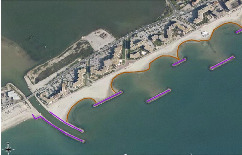
*Illustration 30 : Palavas-Les-Flots (34) – Indicateur levé = limite supérieure du jet de rive (marron) – ouvrages (magenta) – Fond de plan : BdOrtho® 2008*
