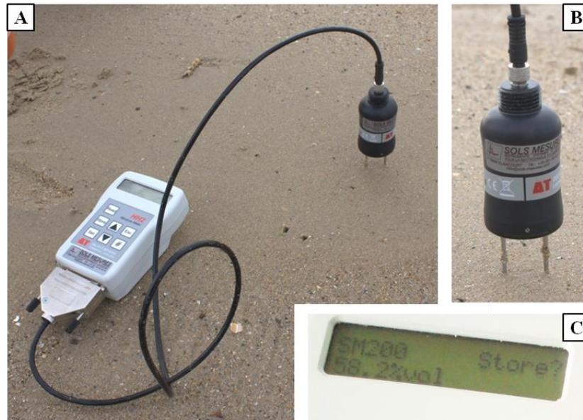
Figure IV.5 : Mesure de la teneur en eau du sol avec la sonde ThetaProbe SM200
