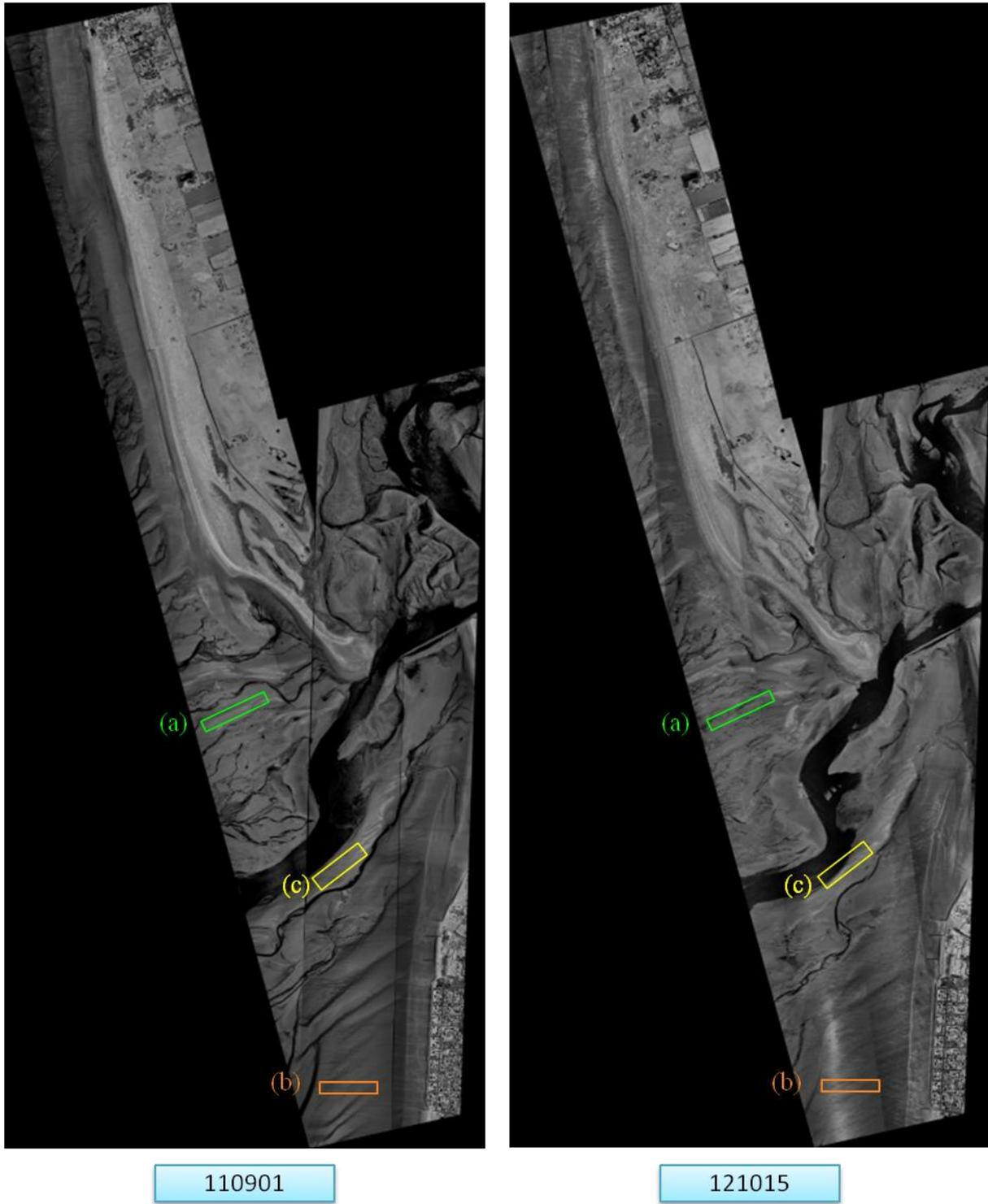
Figure V.9 : Positionnement de trois sites d'études: (a) surface sableuse dont le taux d'humidité à évolué entre les deux vols, (b) zone sableuse avec une humidité constante, (c) apparition d'une zone en eau dans la zone sableuse
